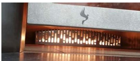
Se la fiamma è troppo gialla può produrre della fuliggine sul soffitto interno del forno.
