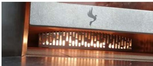
Il normale funzionamento del bruciatore produrrà una fiamma leggermente gialla e non vi sarà presenza di fumo all'interno del forno.
